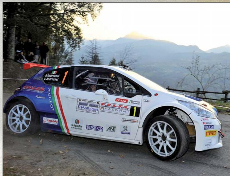
pilota toscano, dopo una stagione dedicata allo sviluppo della nuova Peugeot 208 R2 per i giovani, riprende la striscia tricolore nel 2014 e nel 2015 con la 208 T16 R5. E' la top car per eccellenza, motore 1.6 quattro valvole per cilindro, alimentato con sistema iniezione diretta ad alta pressione Magneti Magneti Marelli, con 280 CV a 6.000 giri/min. e 400 Nm di coppia massima a 2.500 giri/min.
